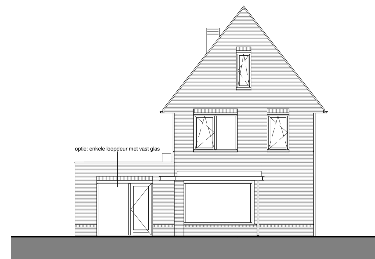
Voorgevel - optie: enkele loopdeur met vast glas
