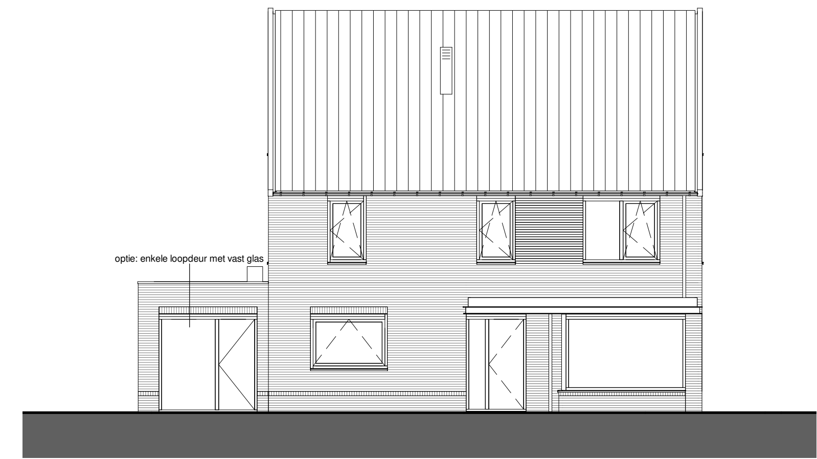
Voorgevel - optie enkele loopdeur met vast glas
